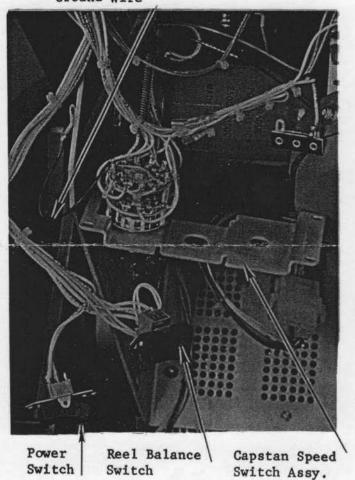
Capstan Speed Amber Lamp Var. Resisto Switch S3 DS2 2.5K Ohm R2
