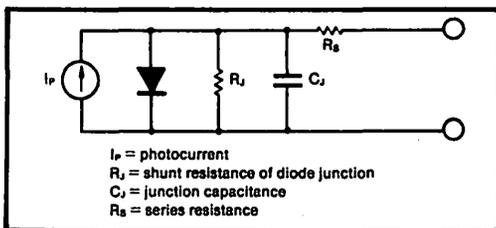
FIGURE 1. Photodiode Equivalent Circuit.
